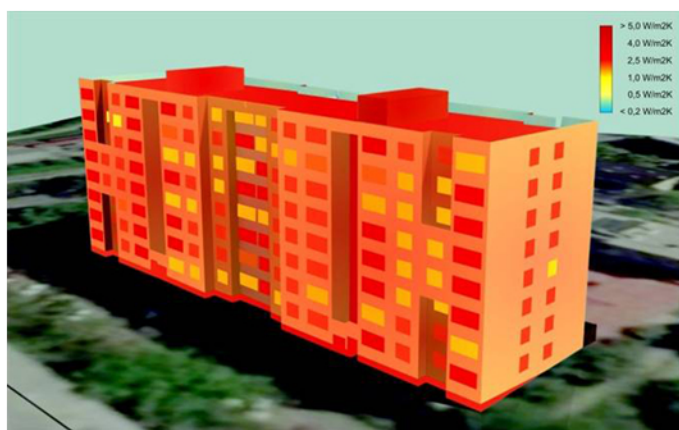
Slika 1. Grafični prikaz prevodnosti toplote pred in po prenovi objekta.
